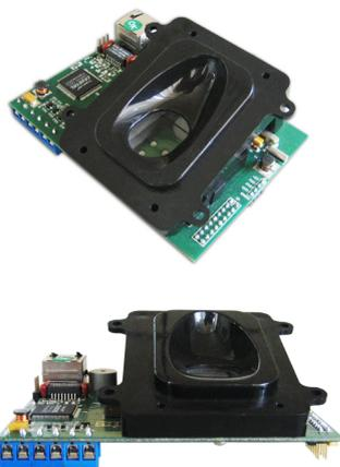
Módulo Biométrico Ethernet
